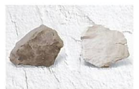
左:7ルノ原産の石灰石 右:950°Cで低温焼成された生石灰
