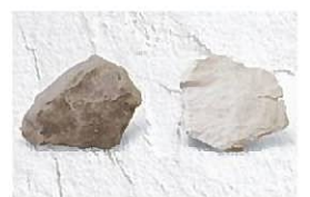
左：7ルノス原産の石灰石 右：950°Cで低温焼成された生石灰
